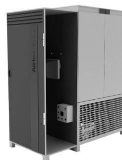
**Airlex V HE2** – теплогенератор внутреннего размещения вертикальной компоновки с осевым вентилятором, поверхностью нагрева из низколегированной или нержавеющей стали и раздаточным пленумом нагретого воздуха (без присоединения к воздуховодам – забор холодного воздуха напрямую из отапливаемого помещения, выдача нагретого воздуха напрямую в отапливаемое помещение через раздаточный пленум).
